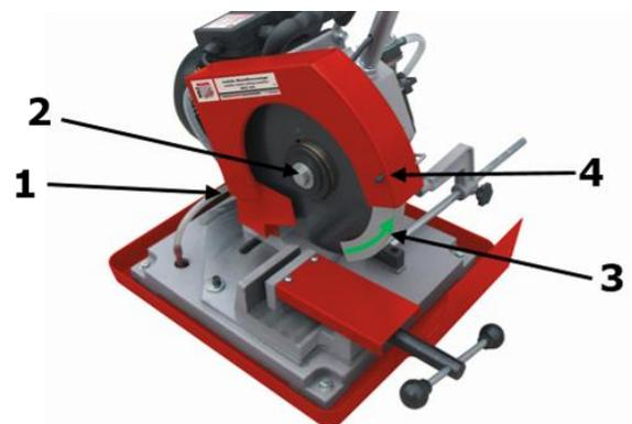
Die Maschine ist mit einer mechanischen Überlastkupplung ausgestattet. Löst diese zu oft aus, ziehen Sie den Sägeblattbolzen fester an.
